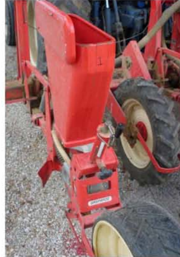
Εικόνες 5.5.3 και 5.5.4. Η πνευματική σπαστική μηχανή που χρησιμοποιήθηκε για τη σπορά.
