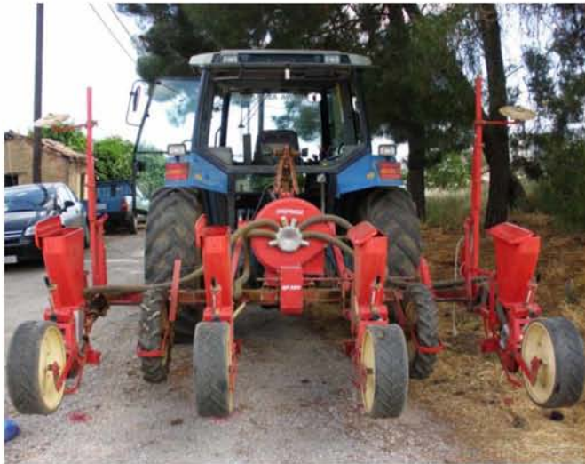
Εικόνες 5.5.3 και 5.5.4. Η πνευματική σπαστική μηχανή που χρησιμοποιήθηκε για τη σπορά.
