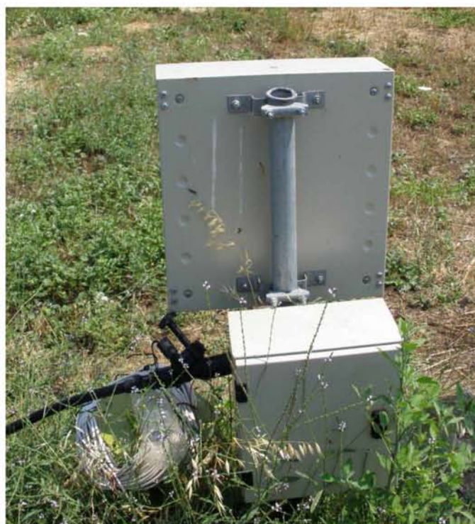
Εικόνα 5.2.4. Ο data logger που χρησιμοποιήθηκε για την συλλογή των κλιματολογικών δεδομένων.
