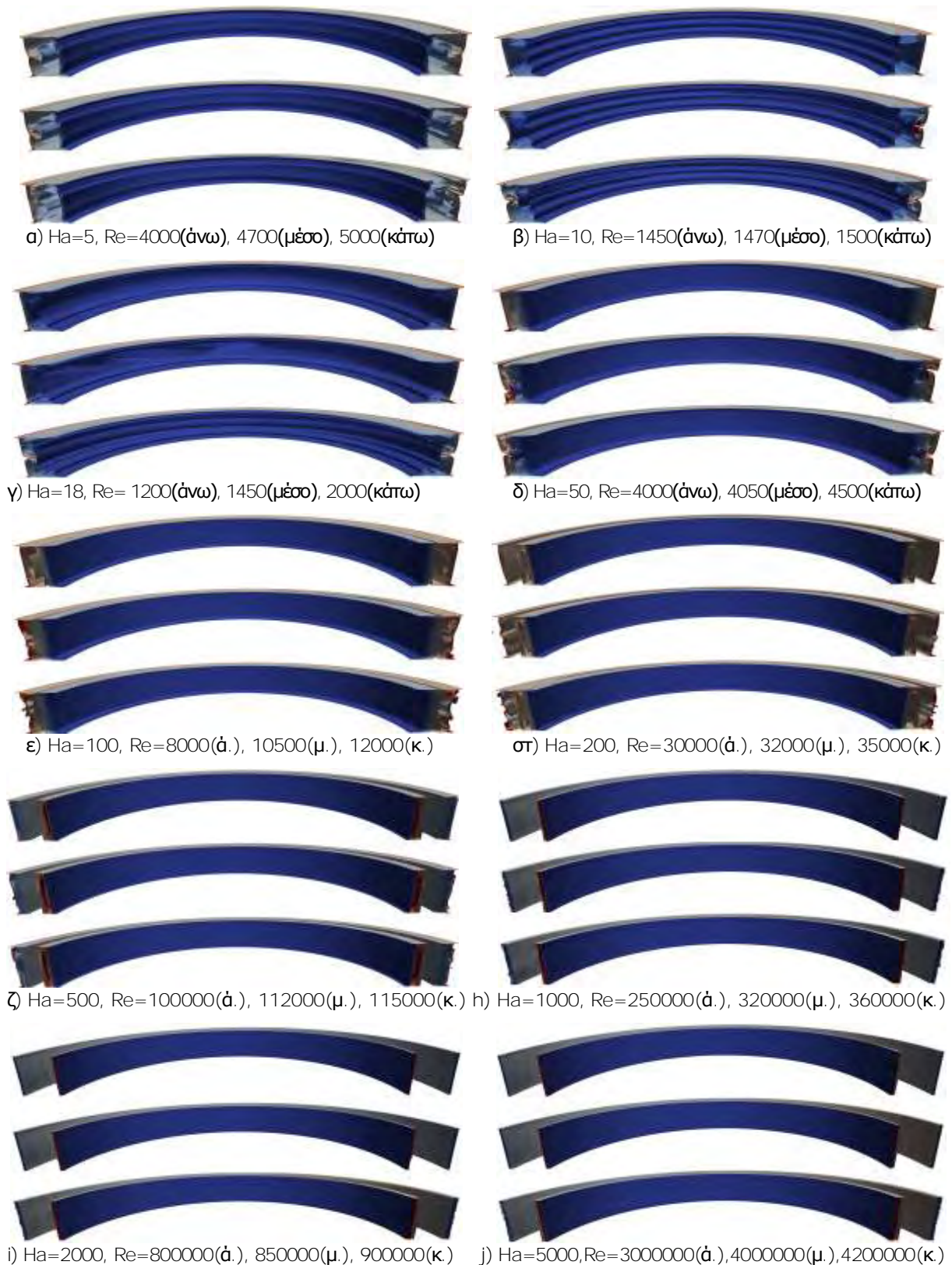
Σχήμα 6.27 Τρισδιάστατη απεικόνιση αξονικής στροβιλότητας. Ροή στρωτή (άνω), μεταβατική (μέσο), τυρβώδης (κάτω)
