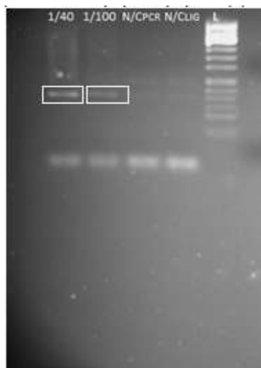
Εικόνα 1.2 Ηλεκτροφόρηση σε gel αгарόζης 4% στα 110V για 3 ώρες. Ηλεκτροφορήθηκαν 5μl από κάθε αραιώση των ditags(+3μl loading buffer) και 1 μl ΦX ladder. Οι σημειωμένες ζώνες έχουν μήκος περίπου 134bp και οι κάτωτερες ζώνες αποτελούν το παραπροϊόν.
