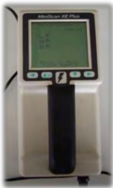
Εικόνα 3.2. Χρωματόμετρο MiniScan XE Plus by Hunterlab.
