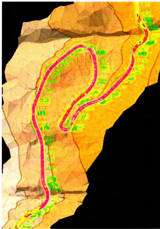
Εικόνα 3.20 Επικίνδυνη κλίση οδοστρώματος από τη Χ.Θ. 5756,70 έως 6320,43 και 6368,42 έως 6604,91
