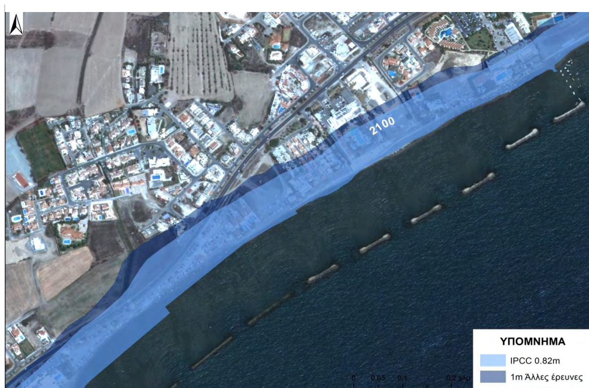
Εικόνα 33: Σενάρια 3 και 4 για ΑΣΘ 0.82μ, 1μ αντίστοιχα το έτος 2100 στην υπόπεριοχή Α
