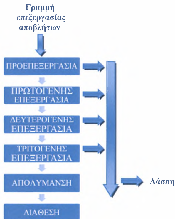
Σχήμα 2: Στάδια και γραμμές επεξεργασίας υγρών αποβλήτων
