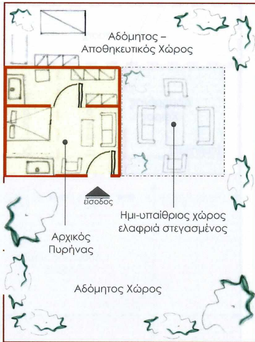
Εικόνα 132 Πιθανή διαμόρφωση αρχικού πυρήνα σε μεσαιου μεγέθους στενομέτωπο οικόπεδο
