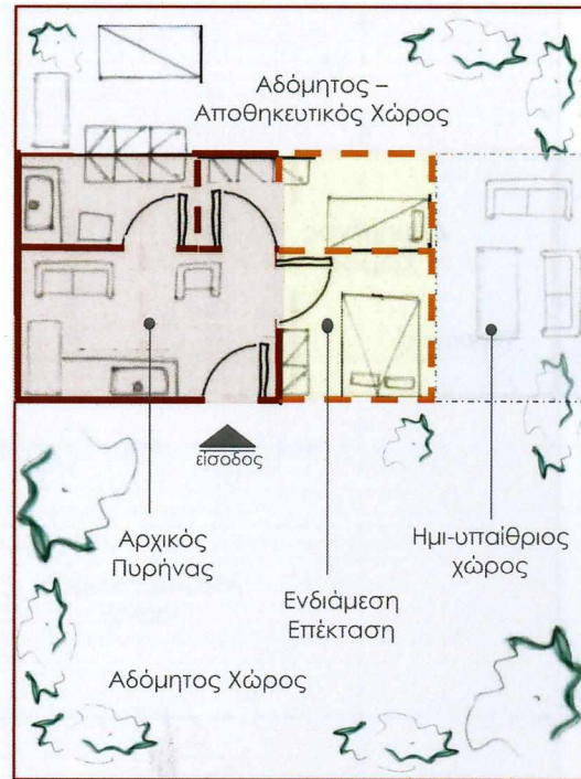
Εικόνα 133 Ενδιάμεσο στάδιο επέκτασης _Εσωτερική διαμόρφωση πυρήνα σε μεσαιου μεγέθους στενομέτωπο οικόπεδο
