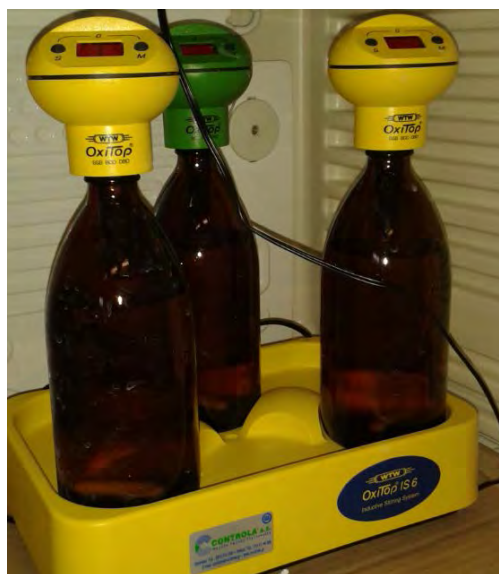
Εικόνα 4.7: Ειδικές φιάλες μέτρησης BOD 5 τοποθετημένες στη συσκευή ανάδευσης
