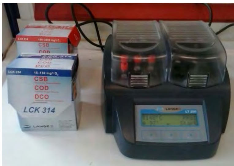
Εικόνα 4.8: Θερμοαντιδραστήρας εταιρείας Hach-Lange (LT 200), κατάλληλος για τη χώνευση δειγμάτων
