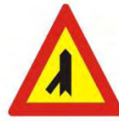
K-29a Διακλάδωση με λοξή οδό αριστερά, οι επί της οποίας κινούμενοι οφείλουν να παραχωρήσουν προτεραιότητα.
