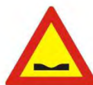
K-11 Επικίνδυνο κάθετο ρείθρο (αυλάκι) ή απότομη κοίλη αλλαγή της κατά μήκος κλίσης της οδού.
