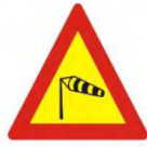
K-23 Κίνδυνος λόγω συχνού ισχυρού ανέμου (όπως δείχνει η κατεύθυνση του ανεμούριου).
