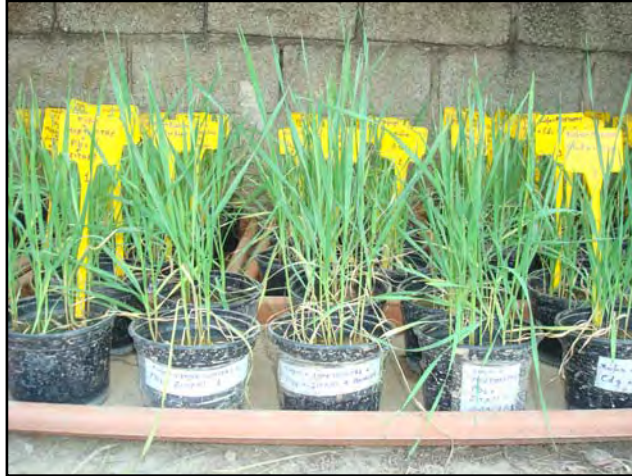
Εικόνα 2.3.2.1.1: Πείραμα προσρόφησης καδμίου σε ζεόλιθο και μπεντονίτη, με ταυτόχρονη καλλιέργεια φυτών σιταριού σε φυτοδοχεία, στο θερμοκήπιο.
