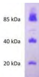
Εικόνα 18. Ηλεκτροφόρηση σε πηκτή πολυακρυλαμιδίου 12%. Δείγμα wash από το 2 ο στάδιο της χρωματογραφίας.
