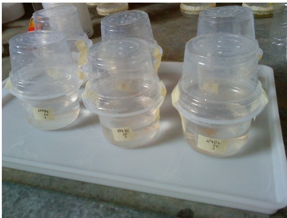
Εικόνα 11: Κάλυψη δοχείων με αντίστοιχα δοχεία με 7 οπές, 5 στο επάνω μέρος και 2 στα πλάγια, με διάμετρο 2 mm.
