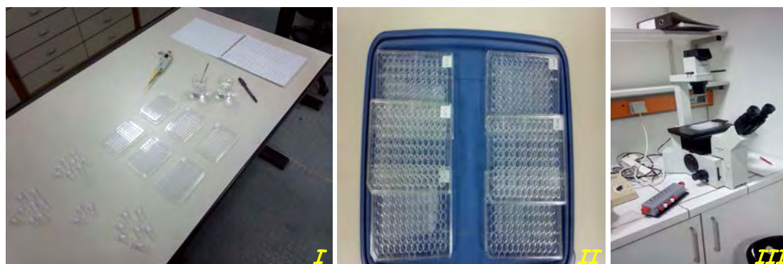
Εικόνα 7 (I) Προσθήκη των διαλυμάτων της κάθε ουσίας σε πλάκα πολυστυρενίου, (II) Πλάκες πολυστυρενίου κλεισμένες με καπάκι, αφού έχει προστεθεί και το διάλυμα με τις προνύμφες, (III) Ανάστροφο μικροσκόπιο.
