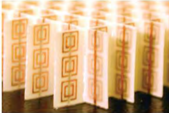
Σχήμα 1.3: Άποψη του πρώτου μεταυλικού που κατασκευάστηκε
