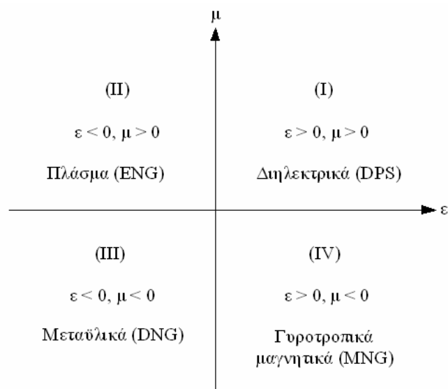
Σχήμα 1.1: Κατηγοριοποίηση των υλικών με βάση τις τιμές των \epsilon και \mu .
