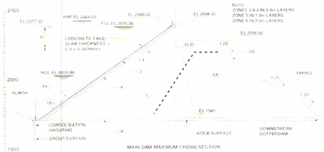
Σχήμα 30: Η κεντρική διατομή του Mohale με λεπτομέρειες της πλίνθου και της κορυφής. [20]
