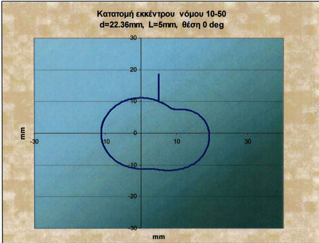
Σχήμα Π1.33: Κατατομή εκκέντρου σημειακής επαφής νόμος κίνησης 10-50, απόστασης επαφής L=5\text{mm} αρχικής ακτίνας R=10\text{mm} υπολογισθείσας τιμής διαμέτρου d=22.36\text{mm} και θέση 0 μοίρες
