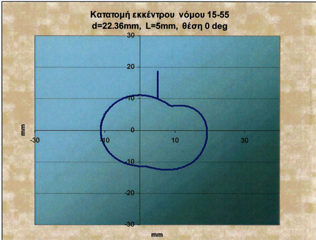
Σχήμα Π1.21: Κατατομή εκκέντρου σημειακής επαφής νόμος κίνησης 15-55, απόστασης επαφής L=5\text{mm} αρχικής ακτίνας R=10\text{mm} υπολογισθείσας τιμής διαμέτρου d=22.36\text{mm} και θέση 0 μοίρες
