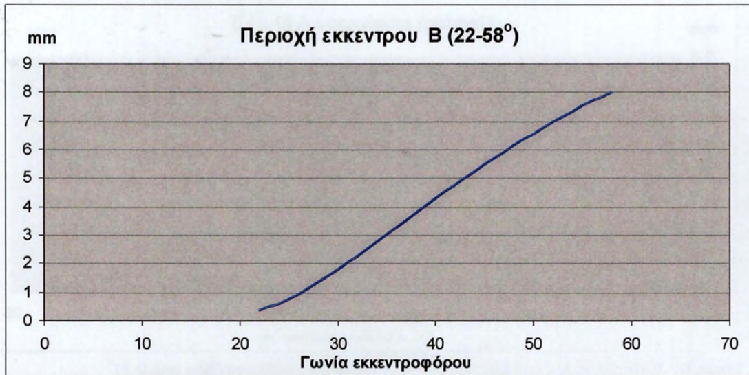
Σχήμα Π2.4: Τμήμα νόμου ανύψωσης 20-60 για μεταβολή εκκεντροφόρου από 22-58° .
