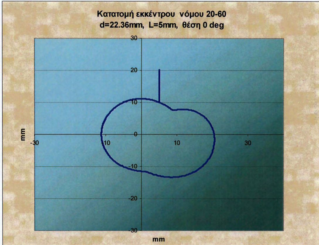
Σχήμα Π1.45: Κατατομή εκκέντρου σημειακής επαφής νόμος κίνησης 20-60, απόστασης επαφής L=5\text{mm} αρχικής ακτίνας R=10\text{mm} υπολογισθείσας τιμής διαμέτρου d=22.36\text{mm} και θέση 0 μοίρες
