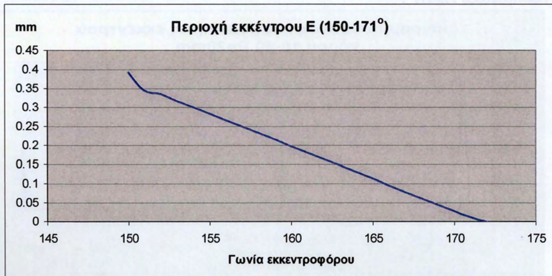
Σχήμα Π2.14: Τμήμα νόμου ανύψωσης 20-60 για μεταβολή εκκεντροφόρου από 150-171° .
