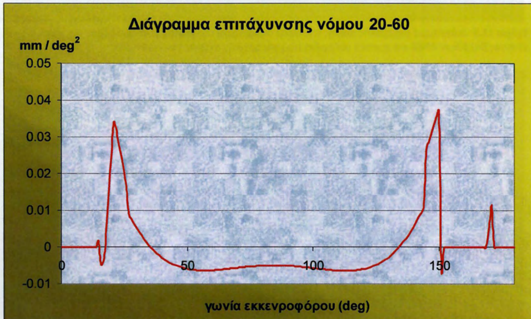
Σχήμα 10.5: Διάγραμμα μεταβολής τιμής επιτάχυνσης ακολούθου (βαλβίδας) συναρτήσει της γωνίας εκκεντροφόρου για «ανοιχτό» νόμο κίνησης βαλβίδων 20-60
