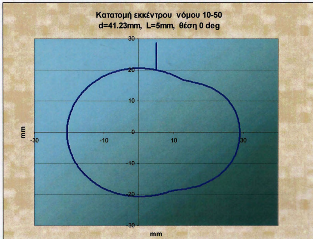
Σχήμα Π1.31: Κατατομή εκκέντρου σημειακής επαφής νόμος κίνησης 10-50, απόστασης επαφής L=5\text{mm} αρχικής ακτίνας R=20\text{mm} υπολογισθείσας τιμής διαμέτρου d=41.23\text{mm} και θέση 0 μοίρες
