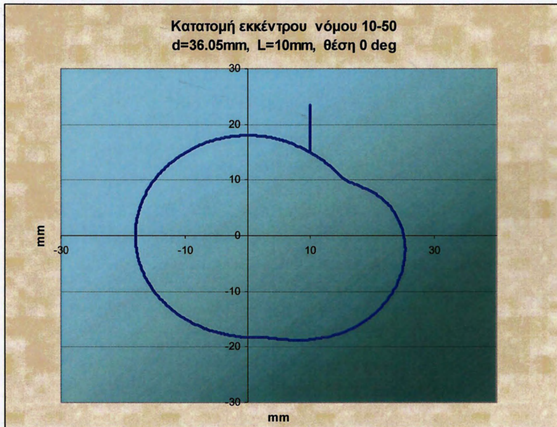
Σχήμα Π1.35: Κατατομή εκκέντρου σημειακής επαφής νόμος κίνησης 10-50, απόστασης επαφής L=10\text{mm} αρχικής ακτίνας R=15\text{mm} υπολογισθείσας τιμής διαμέτρου d=36.05\text{mm} και θέση 0 μοίρες
