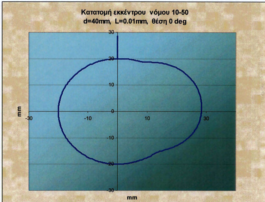
Σχήμα Π1.25: Κατατομή εκκέντρου σημειακής επαφής νόμος κίνησης 10-50, απόστασης επαφής L=0.01\text{mm} αρχικής ακτίνας R=20\text{mm} υπολογισθείσας τιμής διαμέτρου d=40\text{mm} και θέση 0 μοίρες
