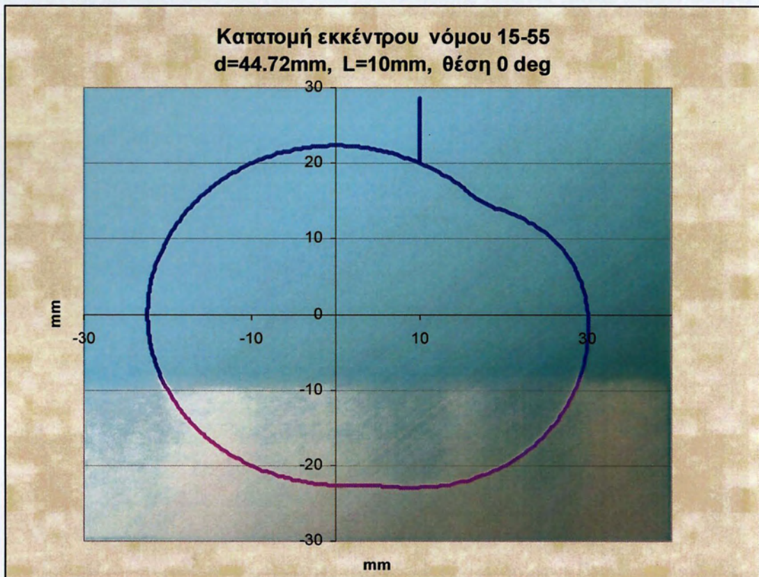
Σχήμα Π1.22: Κατατομή εκκέντρου σημειακής επαφής νόμος κίνησης 15-55, απόστασης επαφής L=10\text{mm} αρχικής ακτίνας R=20\text{mm} υπολογισθείσας τιμής διαμέτρου d=44.72\text{mm} και θέση 0 μοίρες
