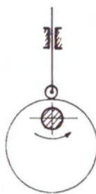
Σχήμα 14.1: Κάμα με ακόλουθο κινούμενο σε ακτινική κατεύθυνση
