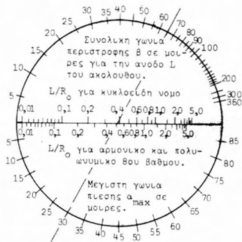
Σχήμα 38.1: Νομόγραμμα εύρεσης της μέγιστης γωνίας πίεσης.
