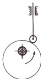
Σχήμα 15.1: Κάμα με ακόλουθο κινούμενο σε μη ακτινική κατεύθυνση
