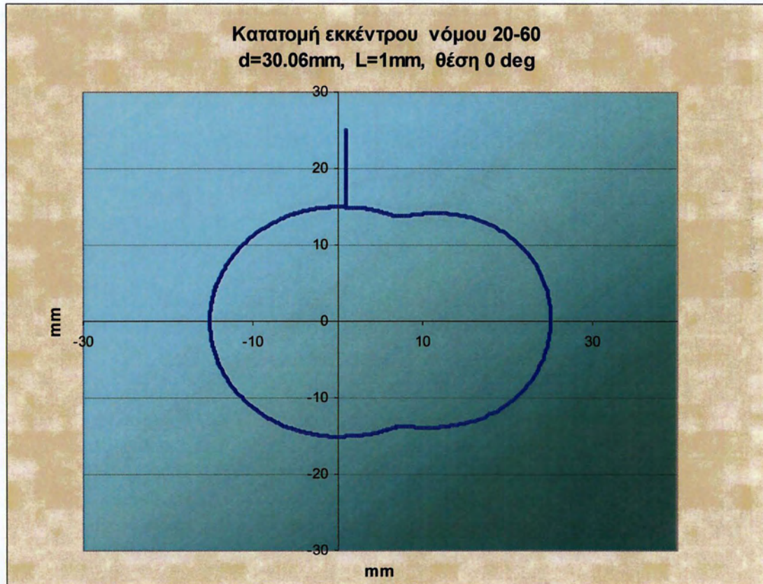
Σχήμα Π1.41: Κατατομή εκκέντρου σημειακής επαφής νόμος κίνησης 20-60, απόστασης επαφής L=1\text{mm} αρχικής ακτίνας R=15\text{mm} υπολογισθείσας τιμής διαμέτρου d=30.06\text{mm} και θέση 0 μοίρες
