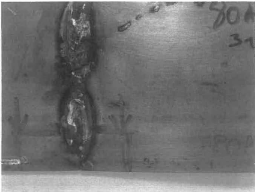
Σχήμα 11 (Συγκόλληση πλακιδίων με ένταση ρεύματος 80A)
