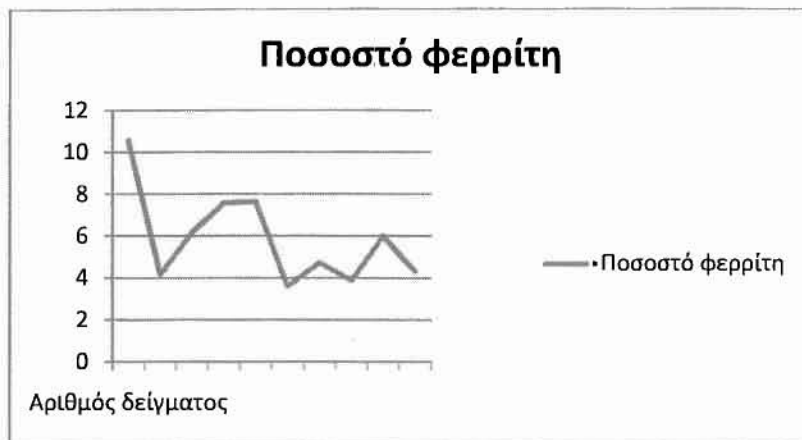
Σχήμα34 (Διασπορά ποσοστού φερρίτη σε δοκίμιο που συγκολλήθηκε με ένταση ρεύματος 70A)
