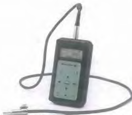
Εικόνα 4.3 / Μετρητής δόσεων θορύβου.
