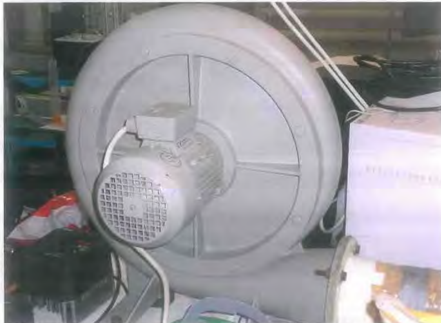
Εικόνα 4.4 / Ο φυγοκεντρικός φουσητήρας που χρησιμοποιήθηκε για την δημιουργία τη δέσμης.
