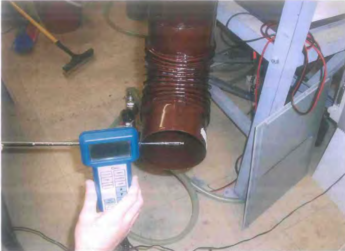
Εικόνα 4.5 / Μέτρηση της ταχύτητας της δέσμης στην έξοδο, με στόμιο εξόδου τύπου γωνίας 90°.
