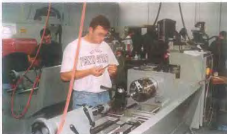
Εικόνα 1.2 / Κλασική πηγή θορύβου στην βιομηχανία είναι οι τόρνοι που χρησιμοποιούνται για την κατεργασία διάφορων μετάλλων.
