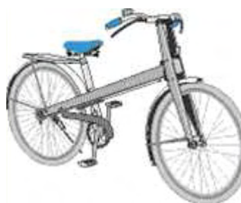
Εικόνα 33: Το πλαίσιο κατασκευάζεται από αλουμίνιο που χρησιμοποιείται στα αεροπλάνα
