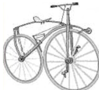
Εικόνα 21: Michaux Velocipede – Η πρώτη μηχανή προς ανάβαση σε μαζική παραγωγή
