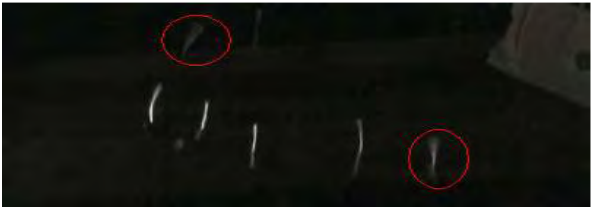
Φωτογραφία 25. Τα νημάτια λίγο πριν την απώλεια στήριξης ( 14^{\circ} - 15^{\circ} ) σε στρωτή ροή
