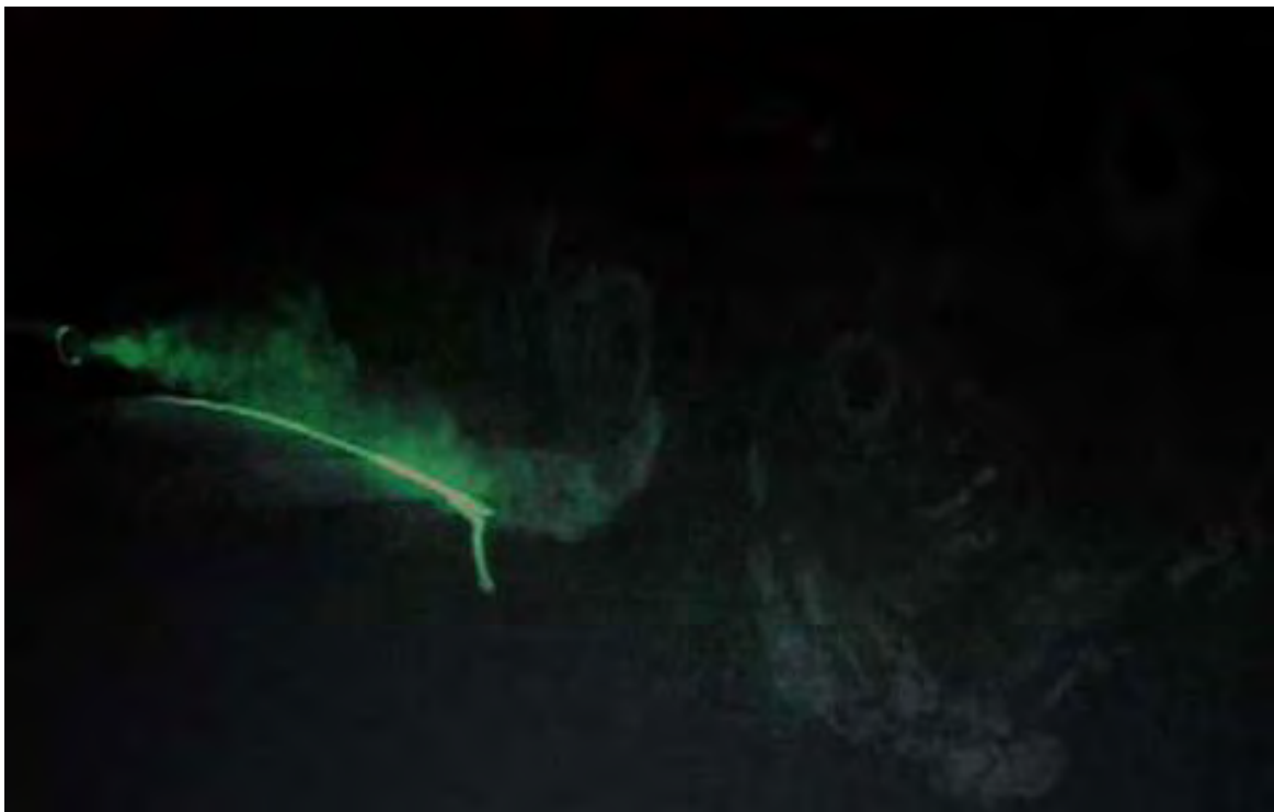
Φωτογραφία 51. Ταλάντωση με f = 9\text{Hz} / γωνία προσβολής +12^\circ / σε τυρβώδη ροή
