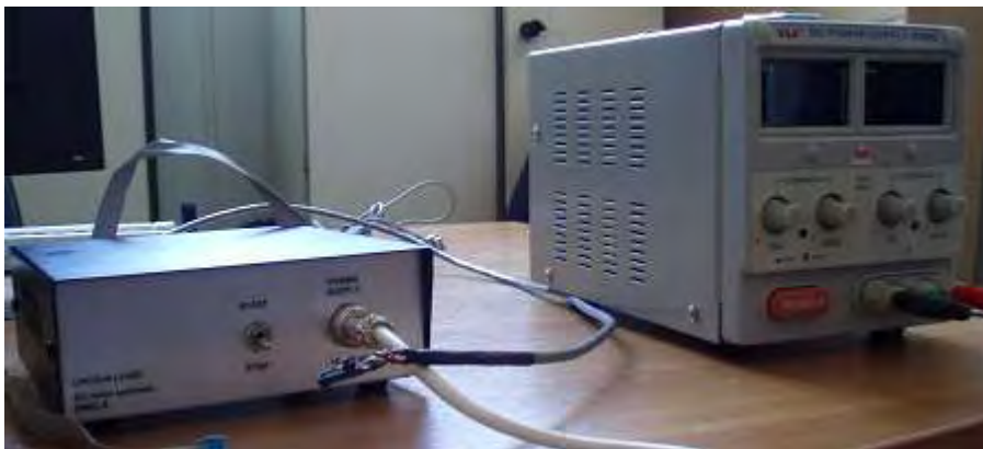
Φωτογραφία 21. Η συσκευή παροχής συνεχούς τάσης στο περιστρεφόμενο κάτοπτρο
