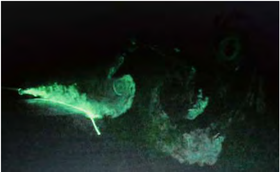
Φωτογραφία 45. Ταλάντωση με f = 8\text{Hz} / γωνία προσβολής +12^\circ / σε στρωτή ροή
