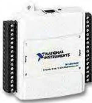
Φωτογραφία 16. Η κάρτα ψηφιοποίησης και ανάκτησης δεδομένων NI USB6009
