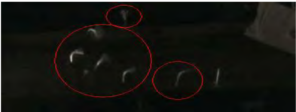
Φωτογραφία 26. Τα νημάτια μετά την απώλεια στήριξης ( 16^{\circ} +) σε στρωτή ροή
