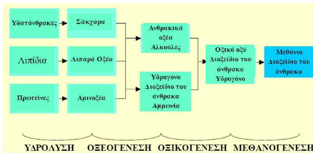
Σχήμα 2.2: Τα κύρια βήματα της διεργασίας της ΑΧ (AL SEADI, 2003)
