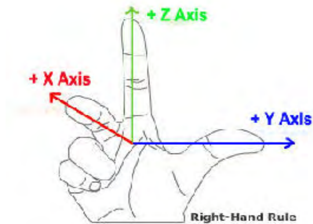
Σχήμα 3.1.1. Ο κανόνας των τριών δακτύλων του δεξιού χεριού. Ο x άξονας εκφράζει το “πάχος” της μηριαίας κεφαλής.
