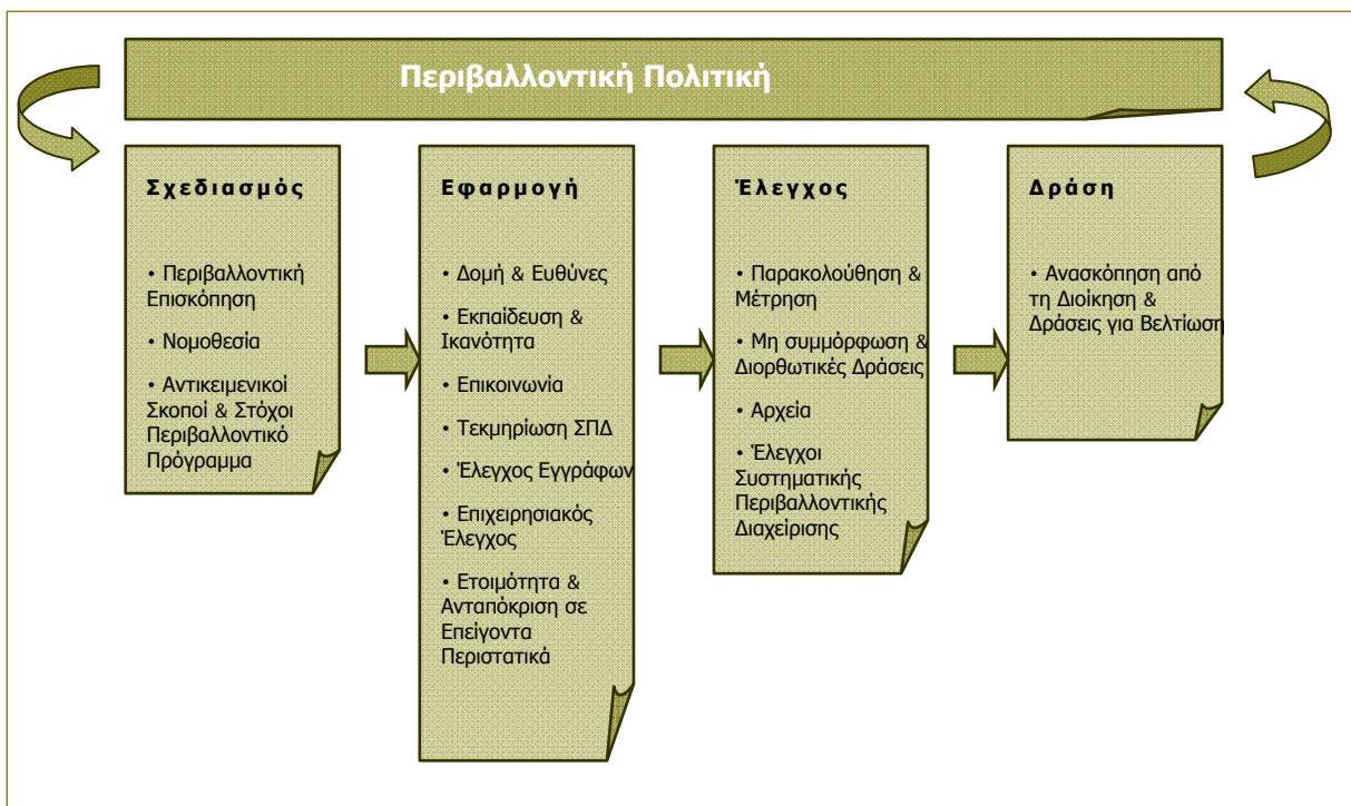
Σχήμα 5.8: Διάγραμμα απεικόνισης του κύκλου του συστήματος περιβαλλοντικής διαχείρισης: «Σχεδιασμός – Εφαρμογή – Έλεγχος – Δράση»
