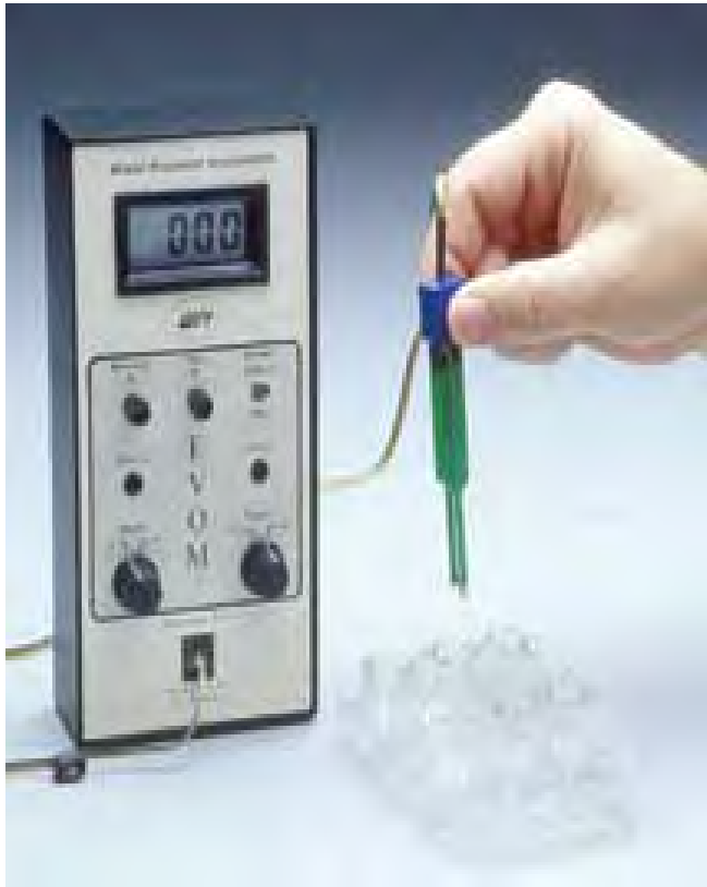
Εικόνα 5: Η συσκευή EVOMX με την οποία μετρούνταν η αντίσταση των μεσοθηλιακών απευθείας από την καλλιέργεια.
