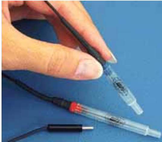
Εικόνα 9: Τύπος ηλεκτροδίων DVC – 3 που χρησιμοποιήθηκαν κατά την επιτέλεση των πειραμάτων.
