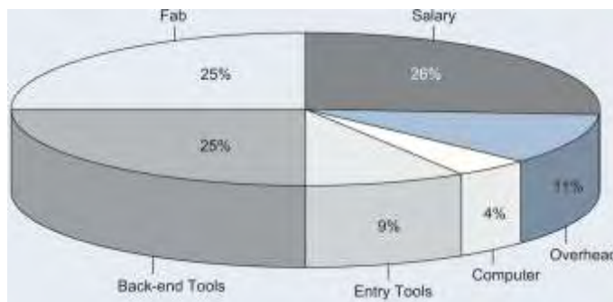
Εικόνα 11. Επιμερισμός το κόστους για την προτυποποίηση ενός αναλογικού-ψηφιακού ΟΚ (mixed-signal chip).
