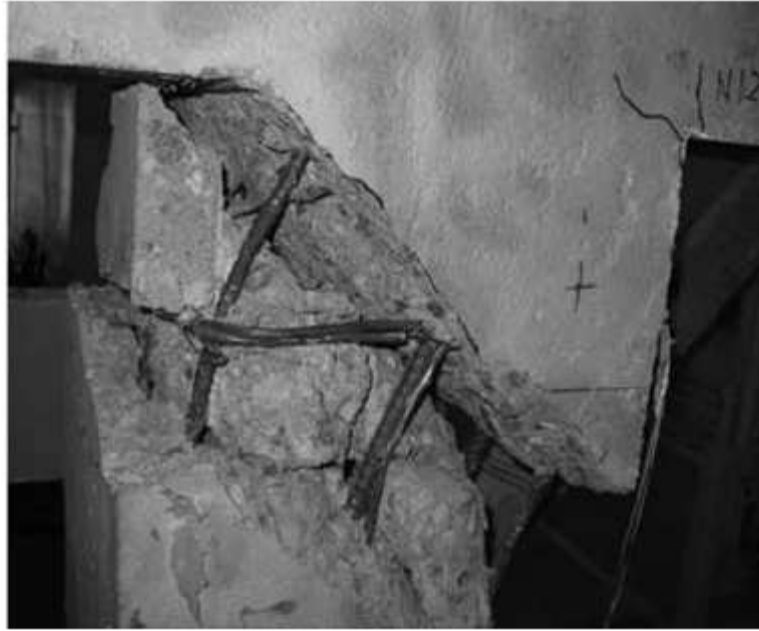
Σχ.3.52 Διατμητική αστοχία πάνω τμήματος του μη φορτιζόμενου υποστυλώματος του δοκιμίου S στο τέλος του πειράματος.
