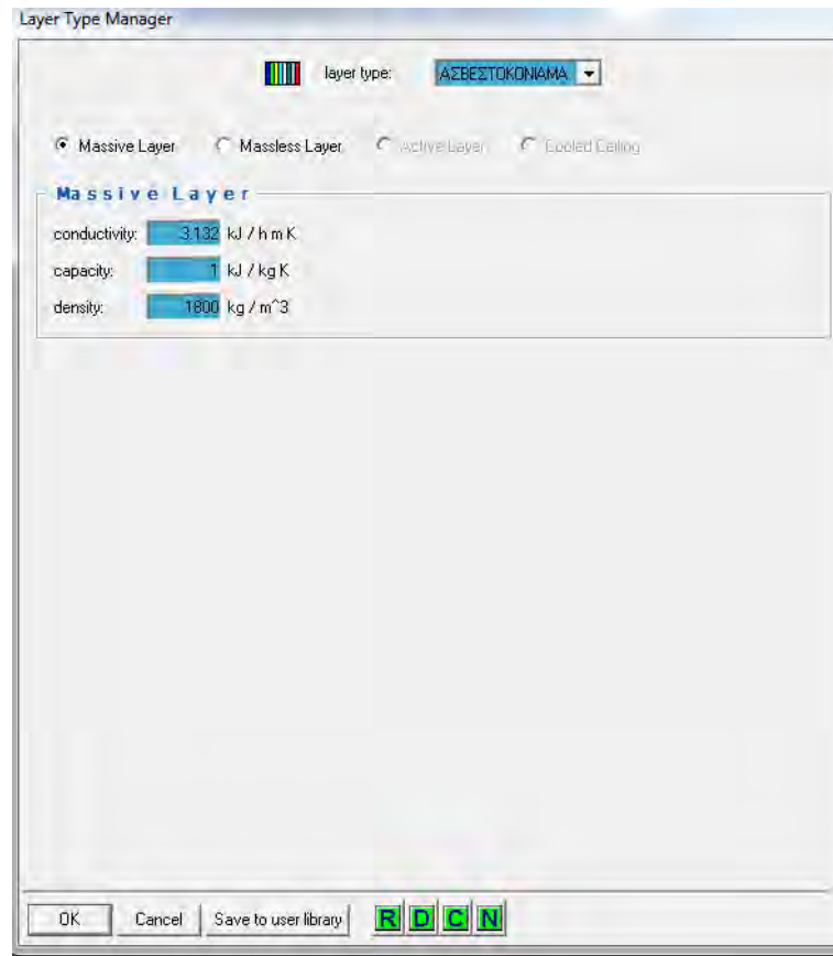
Εικόνα 4-21: Διαχειριστής υλικών στρώσεων δομικών στοιχείων
