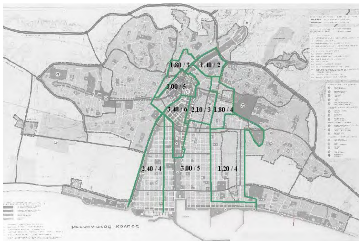
Χάρτης 7. Συντελεστές δόμησης (πρώτος αριθμός) και αριθμός ορόφων (δεύτερος αριθμός) πριν το ΓΠΣ του 1986 (Πηγή: ΚΕΠΑΜΕ, 1988, ίδια επεξεργασία).
