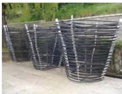
Εικόνα 3.7 Κωνικός γεωεναλλάκτης θερμότητας κλειστού κυκλώματος [15]
