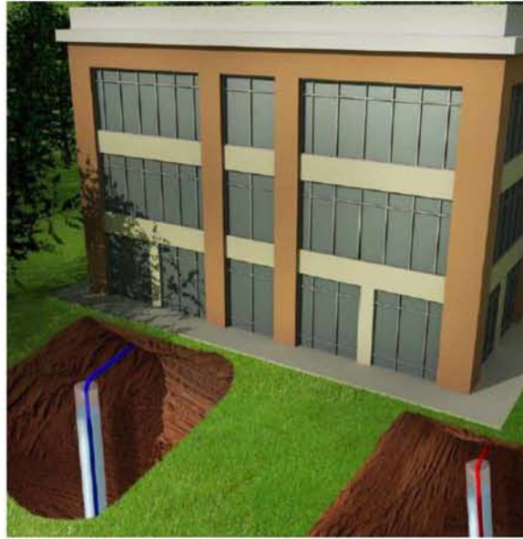
Εικόνα 3.8 Γεωθερμικός εναλλάκτης ανοιχτού κυκλώματος.[13]
