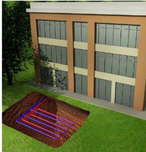
Εικόνα 3.4 Οριζόντια εγκατάσταση των βρόγχων του εναλλάκτη θερμότητας.[13]
