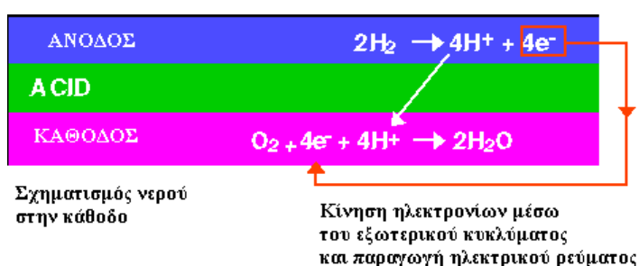
Σχήμα 2.3.1.2 Στοιχείο καυσίμου με ηλεκτρολύτη φωσφορικού οξέος [59].
