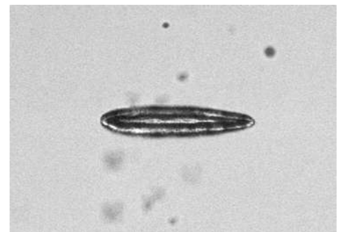
Σχήμα 4.7 Αρχικό σχήμα Φυσαλίδας για παλμού Ενέργειας 100 μJ
