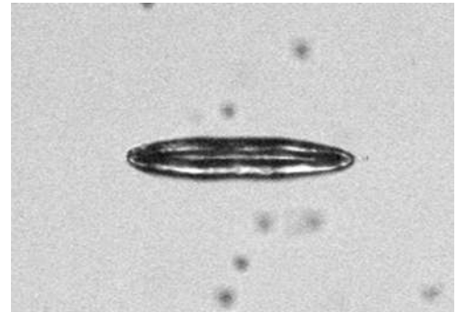
Σχήμα 4.11 Αρχικό σχήμα Φυσαλίδας Ενέργειας 38 μJ
