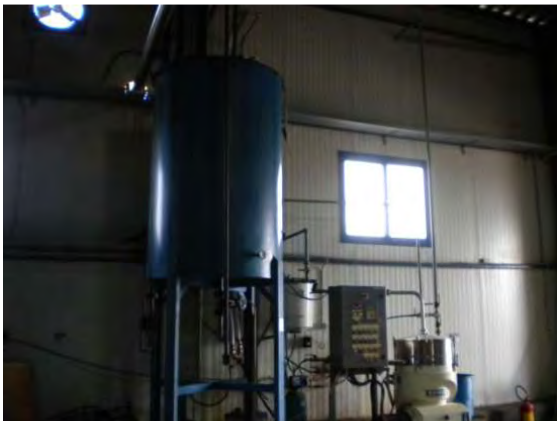
Εικόνα 27: Δεύτερη δεξαμενή λίπους (αριστερά). Κάθετο decanter, όπου γίνεται ο διαχωρισμός λίπους, νερού και τυχόν υπολειμμάτων (δεξιά).
