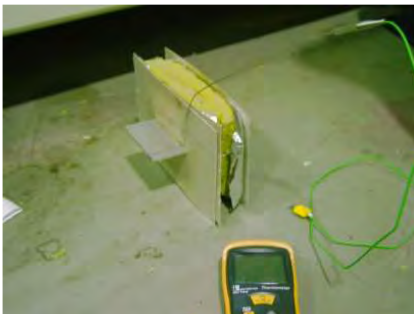
Εικόνα 4.6 Μόνωση δοκιμίου και τοποθέτηση θερμοστοιχείου για έλεγχο της θερμοκρασίας κατά την πειραματική διαδικασία
