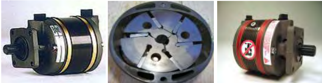
Εικόνα 24: Αντλίες κενού αεροσκαφών
