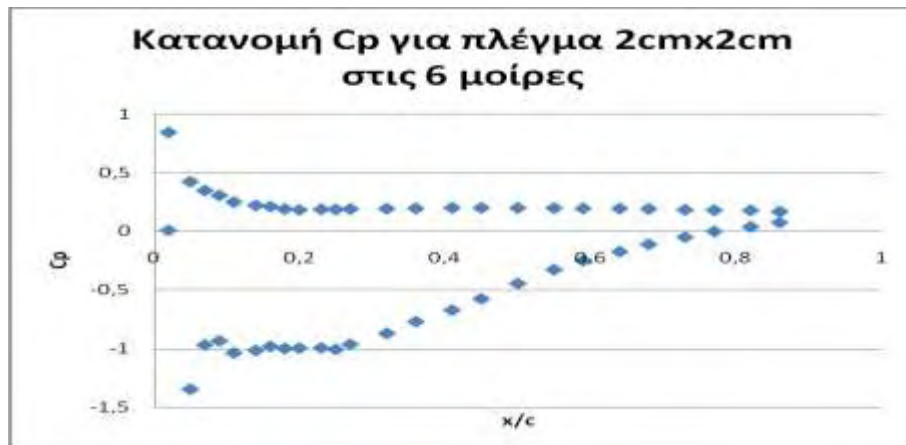
Σχήμα 59 Κατανομή συντελεστή πίεσης για λεία αεροτομή με πλέγμα 2\text{cm} \times 2\text{cm} , \alpha = 6^\circ , V = 5\text{m/s} Για γωνία πρόσπτωσης 12^\circ και ταχύτητα αέρα 5\text{m/s} έχουμε την κατανομή συντελεστή πίεσης C_p , που παρουσιάζεται στο Σχήμα 60.
