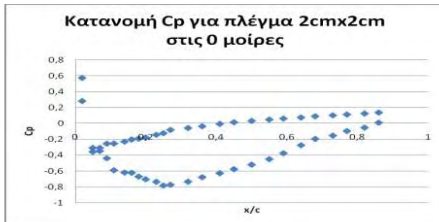
Σχήμα 58 Κατανομή συντελεστή πίεσης για λεία αεροτομή με πλέγμα 2\text{cm} \times 2\text{cm} , \alpha = 0^\circ , V = 5\text{m/s}
