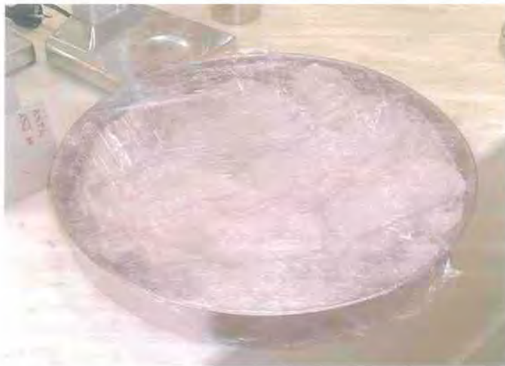
Εικόνα 5.7 Το δοκίμια καλύπτονται με υγρά πανιά, τυλίγονται με αεροστεγή μεμβράνη και αφήνονται να ωριμάσουν για 7 ή 28 μέρες
