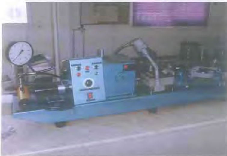
Εικόνα 6.1 Συσκευή διάτμησης που χρησιμοποιήθηκε για την δοκιμή άμεσης διάτμησης
