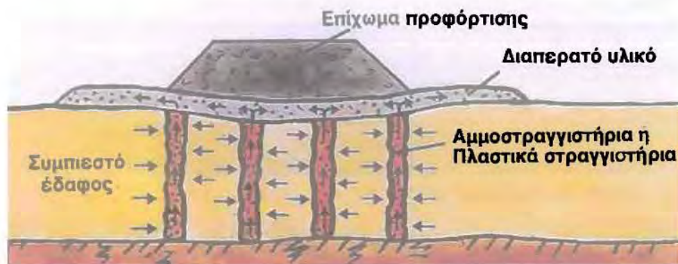
Σχήμα 1.2 Προφόρτιση με τη χρησιμοποίηση αμμοστραγγιστηρίων
