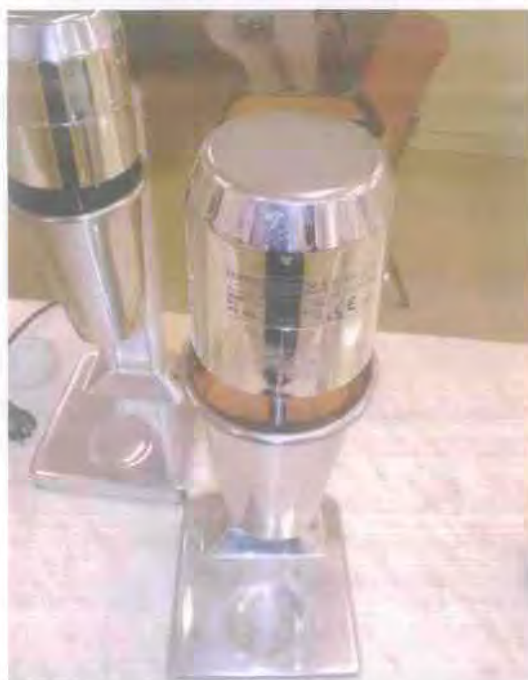
Εικόνα 2.4 Ανάδευση του διαλύματος \text{NaPO}_3 , νερού και εδάφους με μηχανική συσκευή αναδεύσεως
