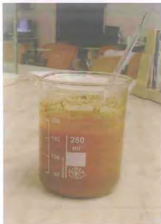
Εικόνα 2.3 Διάλυμα εξαμεταφωσφορικού νατρίου ( \text{NaPO}_3 ) και εδαφικού δείγματος
