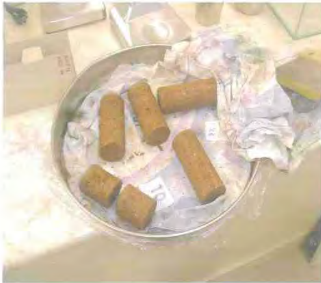
Εικόνα 5.6 Τοποθέτηση των δοκιμίων σε μεταλλικά σκεύη μετά την μόρφωση τους
