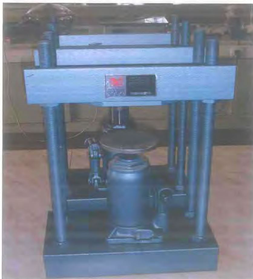
Εικόνα 4.2 Εξολκέας για την εξαγωγή των συμπυκνωθέντων δειγμάτων από την μήτρα
