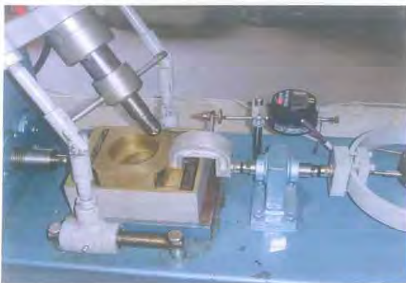
Εικόνα 6.2 Σύστημα επιβολής ορθής και διατμητικής τάσης
