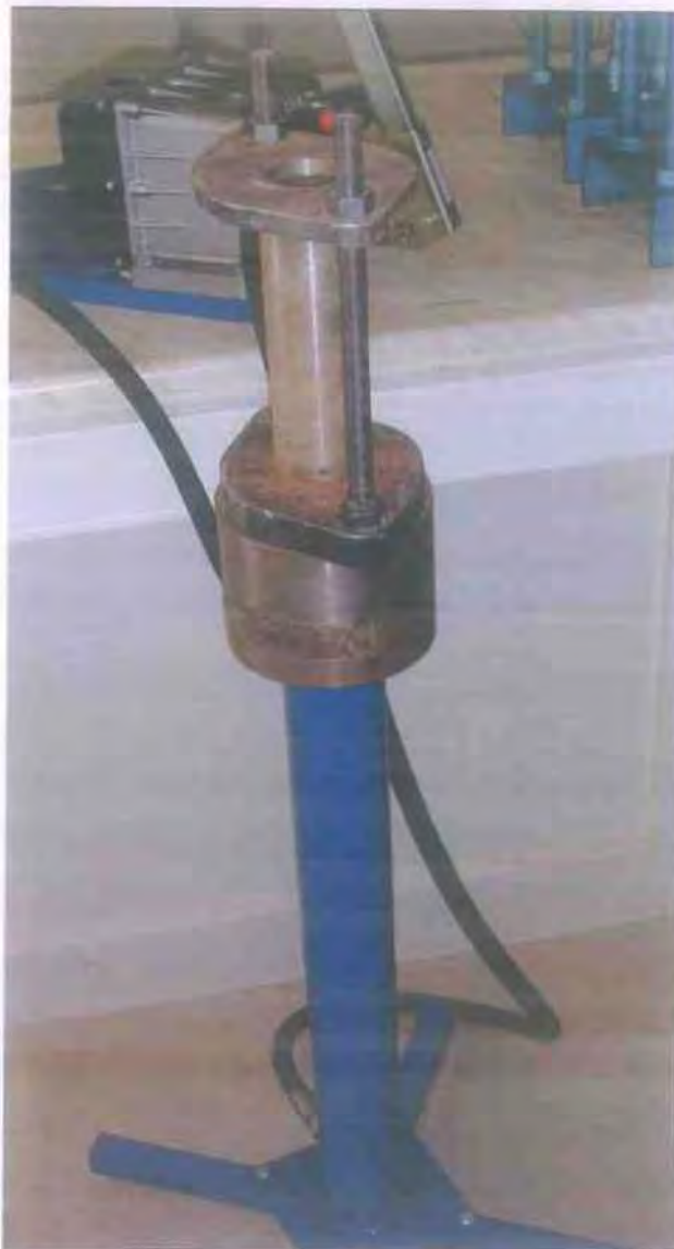
Εικόνα 5.5 Συσκευή για την εξώλκευση κυλινδρικού δοκιμίου από τον δειγματολήπτη
