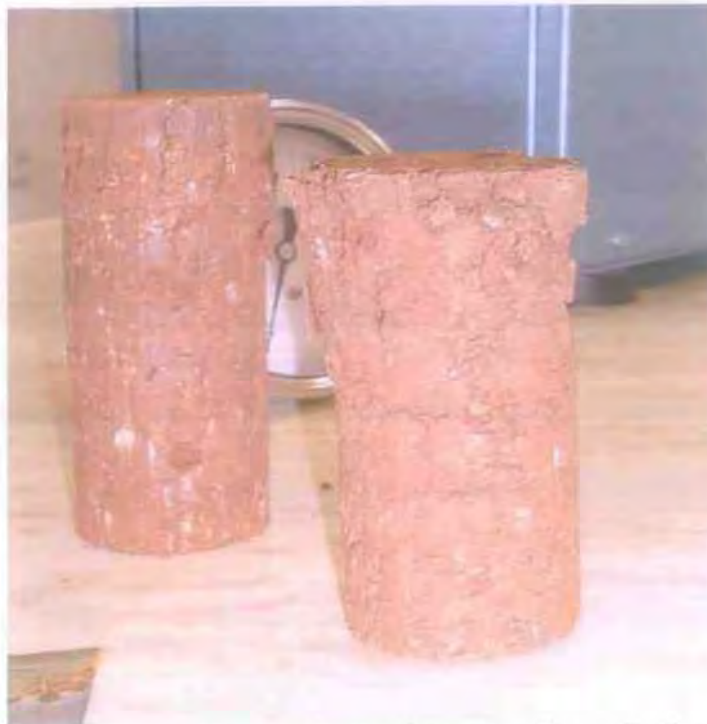
Εικόνα 5.9 Δοκίμια μετά το πέρας της δοκιμής θραύσης
