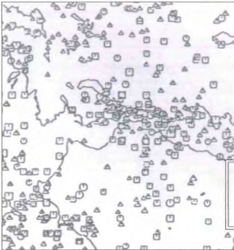
Εικόνα 1.1.5.1. Κατανομή των επικέντρων των σεισμών με μέγεθος M_s > 4 για την χρονική περίοδο 1900 – 1991 σε απόσταση μιας μοίρας από την πόλη της Πάτρας
