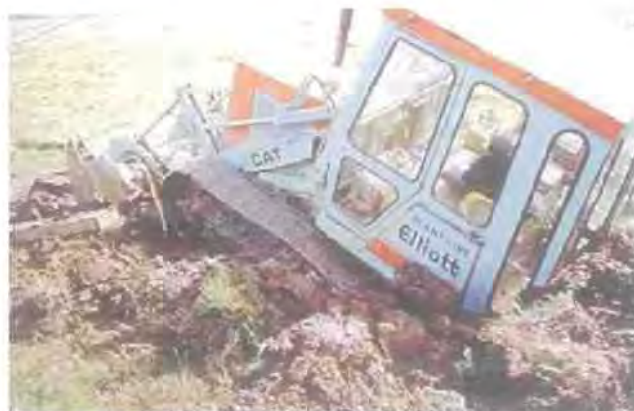
Εικόνα 3.23 Ασθενές έδαφος χωρίς ενίσχυση
