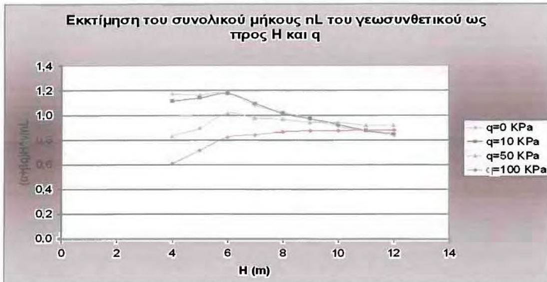
Σχήμα 6.45 Ακρίβεια εμπειρικής σχέσης (6.7) εκτίμησης του συνολικού μήκους του γεωσυνθετικού nL ως προς το ύψος H και την επιφόρτιση q, σύμφωνα με τη μεθοδολογία Β για μη συνεκτικό έδαφος επίχωσης
