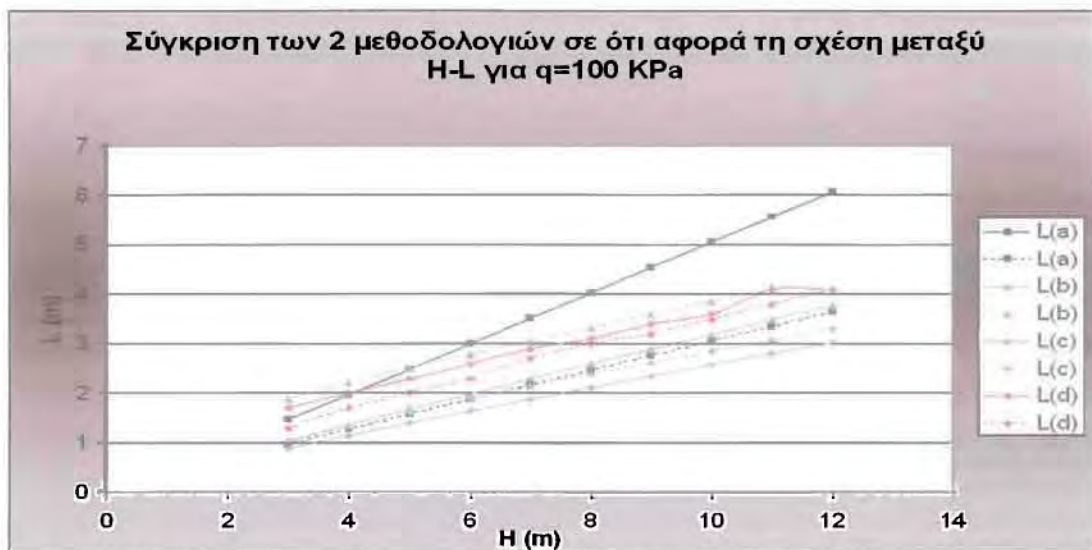
Σχήμα 6.72 Σύγκριση προβλέψεων μεθοδολογιών A και B για επίδραση του ύψους H στις τιμές πλάτους L του τοίχου που εκτιμώνται από τους 4 ελέγχους, για μη συνεκτικό έδαφος επίχωσης και ομοιόμορφη επιφόρτιση q = 100 KPa
