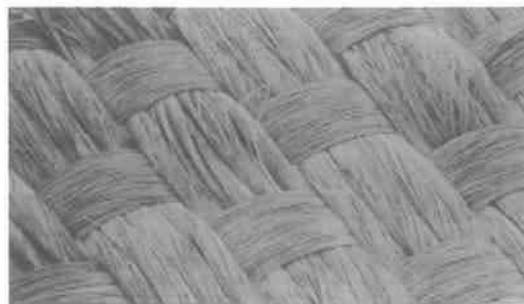
Εικόνα 3.2 Υφαντό GT από πολλαπλές ίνες
