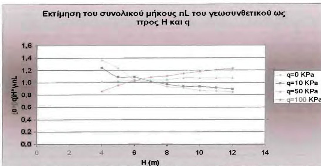
Σχήμα 6.30 Ακρίβεια εμπειρικής σχέσης (6.5) εκτίμησης του συνολικού μήκους του γεωσυνθετικού nL ως προς το ύψος H και την επιφόρτιση q, σύμφωνα με τη μεθοδολογία A για συνεκτικό έδαφος επίχωσης
