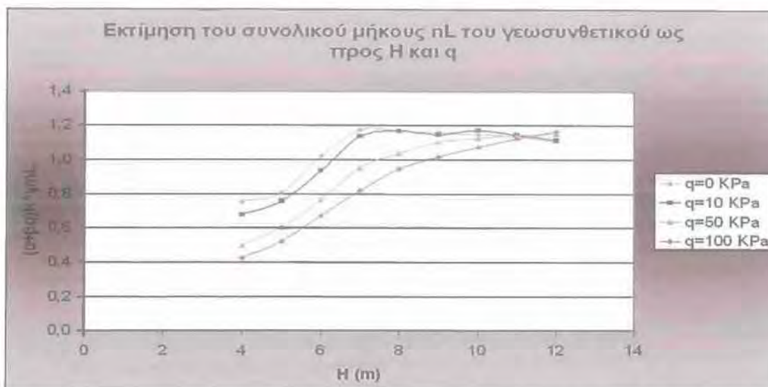
Σχήμα 6.60 Ακρίβεια εμπειρικής σχέσης (6.5) εκτίμησης του συνολικού μήκους του γεωσυνθετικού nL ως προς το ύψος H και την επιφόρτιση q , σύμφωνα με τη μεθοδολογία Β για συνεκτικό έδαφος επίχωσης
