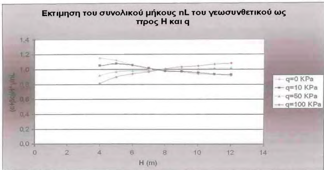
Σχήμα 6.15 Ακρίβεια εμπειρικής σχέσης (6.5) εκτίμησης του συνολικού μήκους του γεωσυνθετικού nL ως προς το ύψος H και την επιφόρτιση q, σύμφωνα με τη μεθοδολογία A για μη συνεκτικό έδαφος επίχωσης
