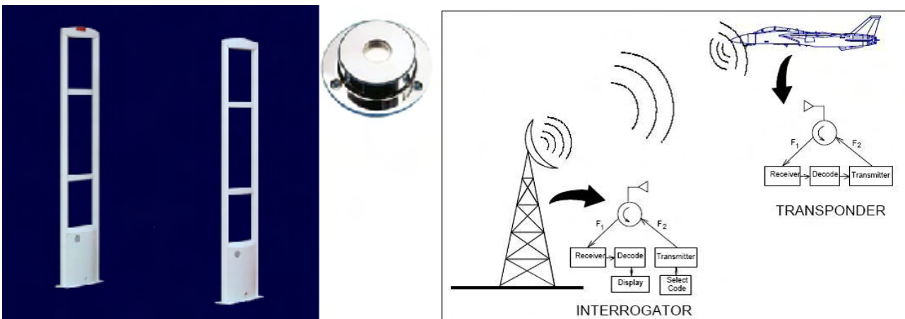
Σχήμα 1.3 Αριστερά ένας κόμβος EAS,στη μέση μία ετικέτα(tag) EAS, δεξιά ένα σύστημα IFF
