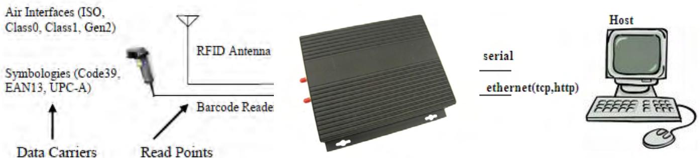
Σχήμα 3.3 Μοντέλο συστήματος RFID και πρωτόκολλα επικοινωνίας ReaderDevice
