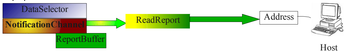
Σχήμα 9.18 Ροή πληροφορίας όταν κάνει fire ένα NotificationTrigger
