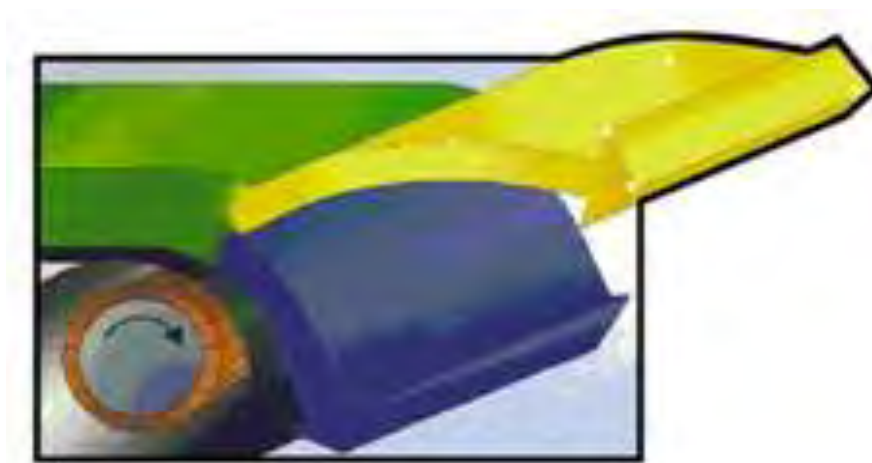
Εικόνα 3.7 Αρχή λειτουργίας επαγωγικού διαχωρισμού (Eddy Current)
