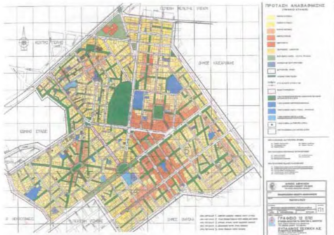
εικ.6: Πολεοδομική μελέτη αναβάθμισης περιοχής Παγκρατίου. Πρόταση αναβάθμισης. Διακρίνονται οι κινήσεις των πεζών με πράσινο, οι κινήσεις των τροχοφόρων με τις κατευθύνσεις τους, οι ειδικές παρεμβάσεις (όπως π.χ. η υπόγεια κίνηση ή στάθμευση τροχοφόρων)
