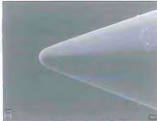
Εικόνα 3.2 : Ηλεκτρομικρογραφία μιας ακίδας 40^\circ κατασκευασμένη από διαμάντι.
