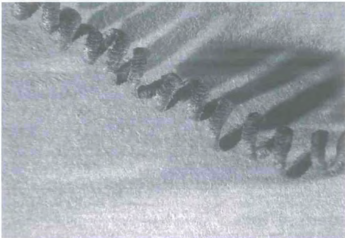
Εικόνα 3.4.9. : Ασυνεχές απόβλιττο ελικοειδού σχήματος για s = 0,32 mm/ στρ.
