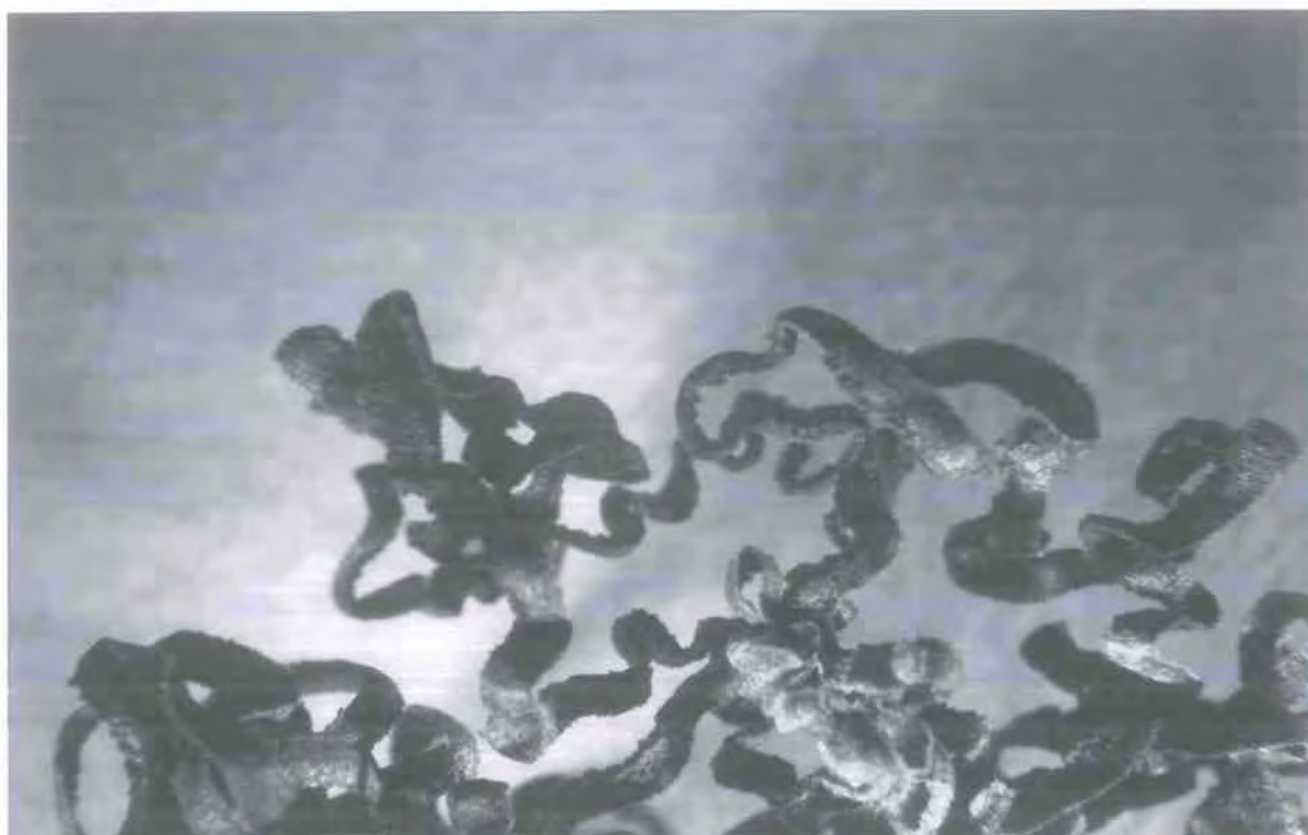
Εικόνα 3.4.5. : Συνεχές απόβλαττο σπειροειδούς σχήματος για s = 0,16 mm/ στρ.
