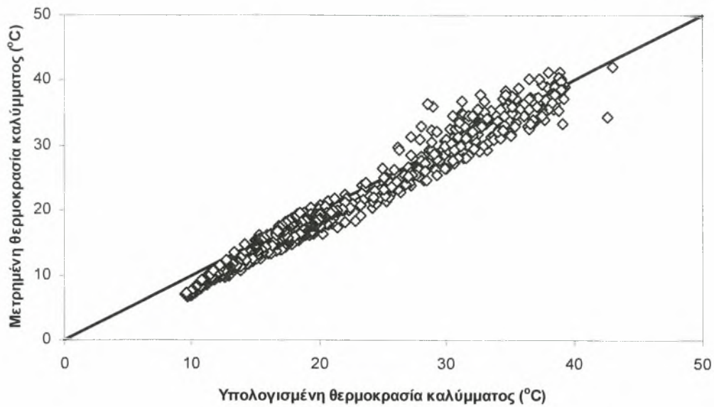
Σχήμα 5.9 (Kittas) Μετρημένες και υπολογισμένες τιμές της θερμοκρασίας του καλύμματος σε (1:1) απεικόνιση, για τη δεύτερη πειραματική περίοδο με χρήση του εμπειρικού τύπου του Kittas.
