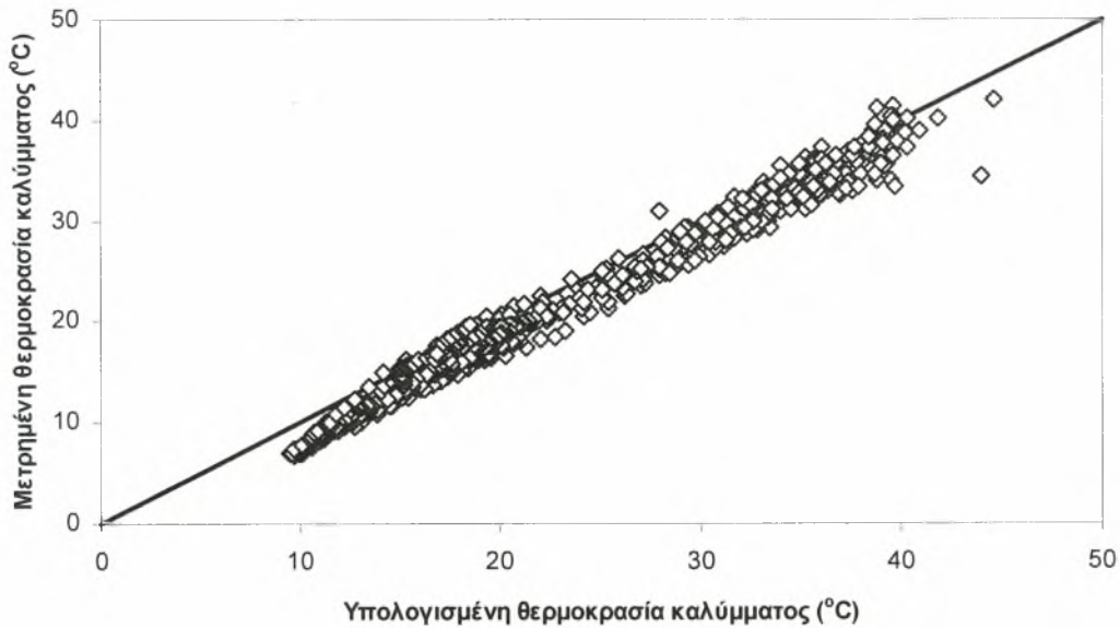
Σχήμα 5.2 (b). Μετρημένες και υπολογισμένες τιμές της θερμοκρασίας του καλύμματος σε (1:1) απεικόνιση, για τη δεύτερη πειραματική περίοδο
