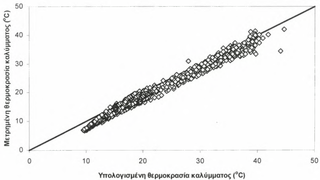
Σχήμα 5.9 (Bot) Μετρημένες και υπολογισμένες τιμές της θερμοκρασίας του καλύμματος σε (1:1) απεικόνιση, για τη δεύτερη πειραματική περίοδο με χρήση του εμπειρικού τύπου του Bot.
