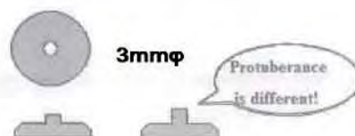
Σχήμα 3.5 Επιθυμητές διαστάσεις του δίσκου και του δείγματος για τη μέτρηση του φάσματος μέσω της τεχνικής FTIR [1]
