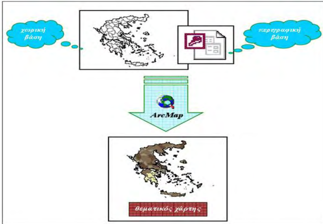
Εικόνα 16- Παράδειγμα κατασκευής θεματικού χάρτη μέσω εφαρμογής ArcCatalog του ArcGis (Gis Mapping Software,Solutions, Services,Map Apps and Data)
