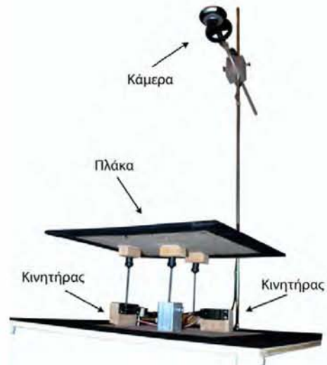
Σχήμα 4.2: Κατασκευή του συστήματος με άξονες [18]
