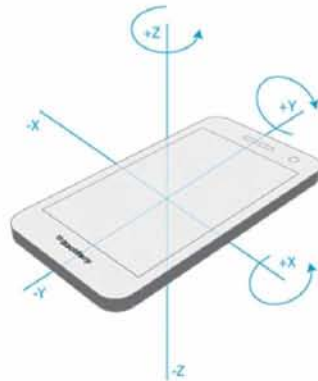
Σχήμα 4.7: Οι άξονες περιστροφής που διαβάζει ο αισθητήρας περιστροφής [45]
